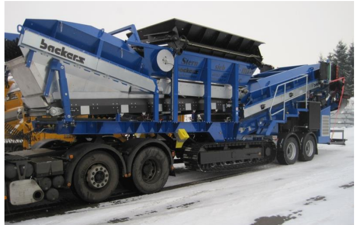
Straßentransport per Sattelaufleger, am Einsatzort per Raupenfahrwerk
