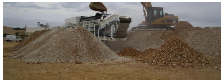
Straßentransport per Sattelaufleger, am Einsatzort per Raupenfahrwerk
